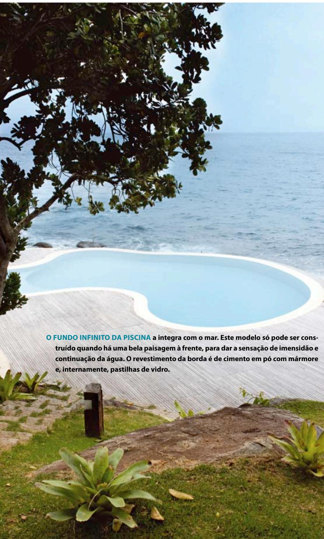
**O FUNDO INFINITO DA PISCINA** a integra com o mar. Este modelo só pode ser construído quando há uma bela paisagem à frente, para dar a sensação de imensidão e continuação da água. O revestimento da borda é de cimento em pó com mármore e, internamente, pastilhas de vidro.
