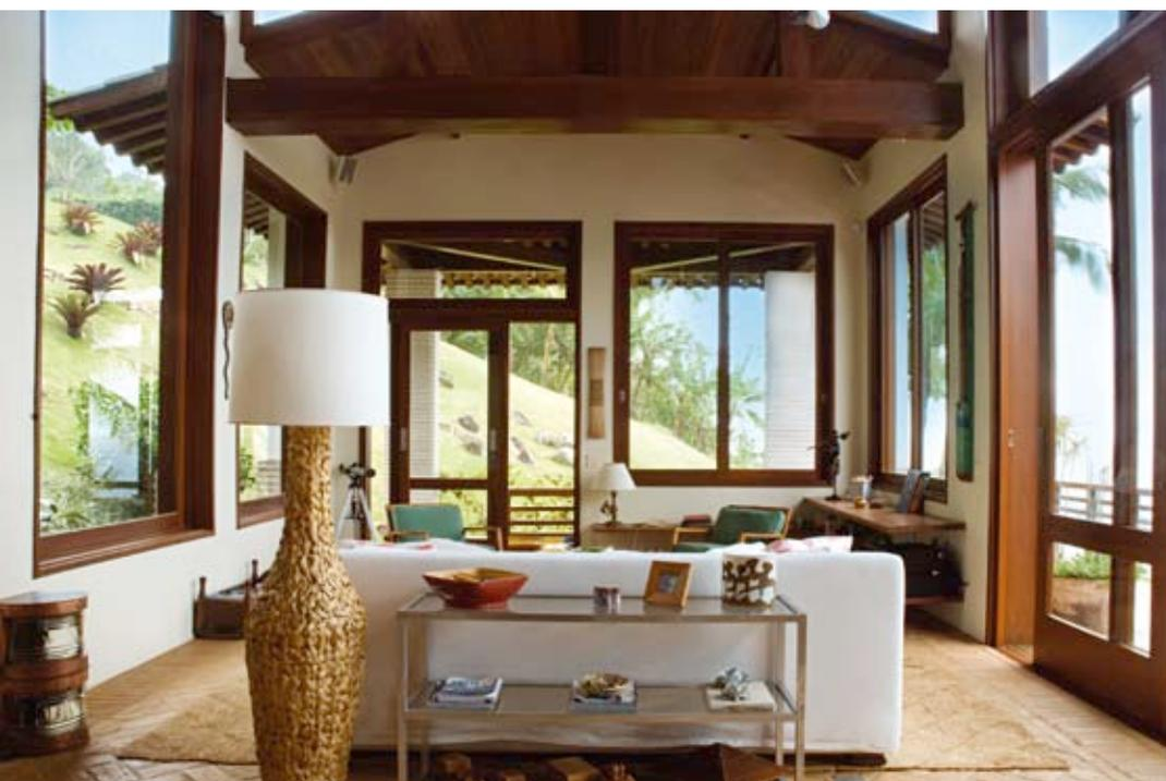
**MUITOS VIDROS ESPALHADOS** e o jogo de telhados trouxeram mais claridade interna. Na imagem, o telhado de três águas foi construído apenas para dar mais charme à fachada, e está um nível abaixo da cobertura de toda a sala. A rusticidade se faz presente nas esquadrias de madeira, vigas aparentes e piso de tijolos de barro. Ao mesmo tempo, as grandes aberturas com vidro são características da arquitetura contemporânea.
